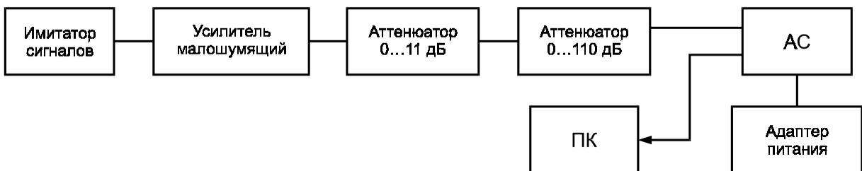
Рисунок Д.3 — Схема определения чувствительности модуля ГНСС
