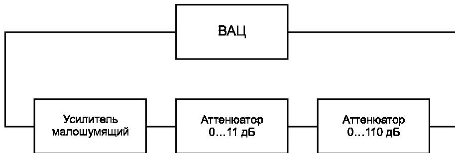
Рисунок Д.2 — Схема калибровки тракта
